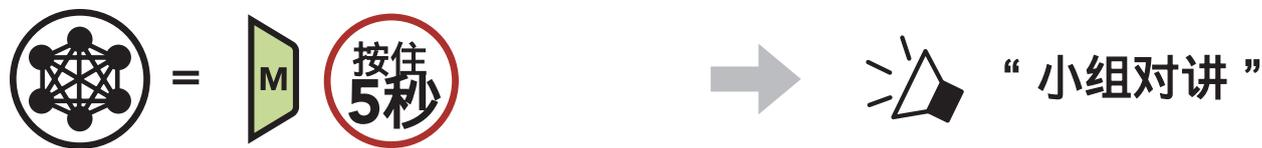
2. 耳机完成Mesh网状分组后，新成员会听到语音提示，他们的耳机会自动从Open Mesh（开放对讲）切换到Group Mesh（小组对讲）。
