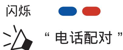
2. 在检测到的蓝牙设备列表中选择 SPIDER ST1。如果您的手机要求输入PIN，请输入0000。
