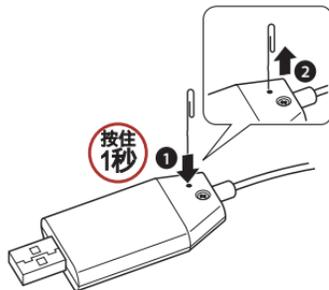
2. WiFi 适配器将在三个 LED 亮起的情况下自动重启。 will automatically restart with the three
