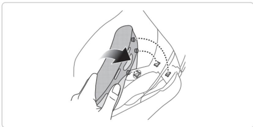
1. 将帽带穿过脸颊垫的孔，然后将脸颊垫的三个紧固件扣入合适的位置。
