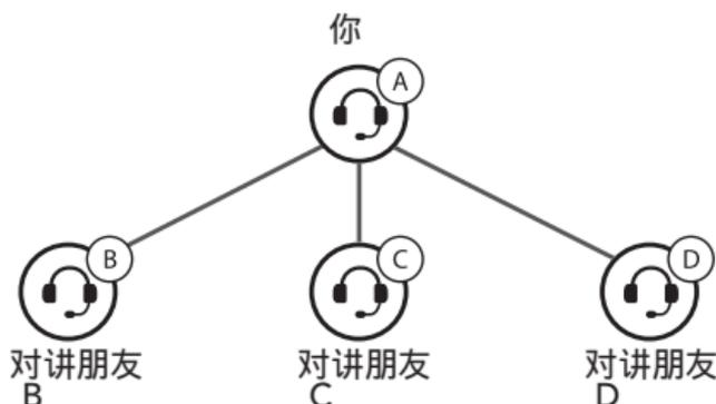
1. 按住蓝牙系统A和B的中心键5秒，直到两个蓝牙系统LED状态灯开始快速红色闪烁，直到您听到语音提示“对讲配对”。
