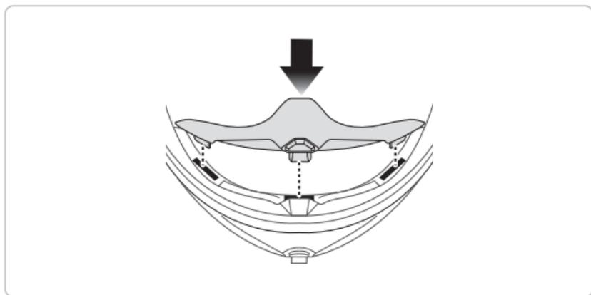
将呼吸保护罩的三个突耳插入卡槽。
