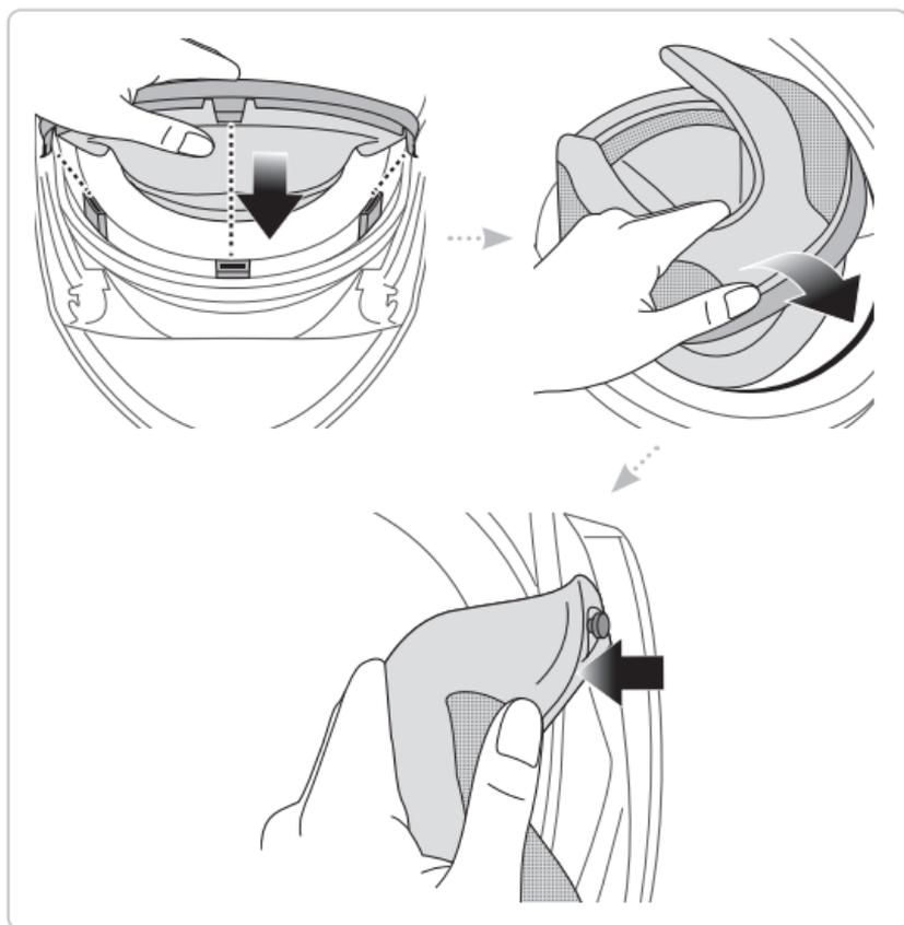
1. 对准并插入三个突耳的内垫到前面部分的槽。
