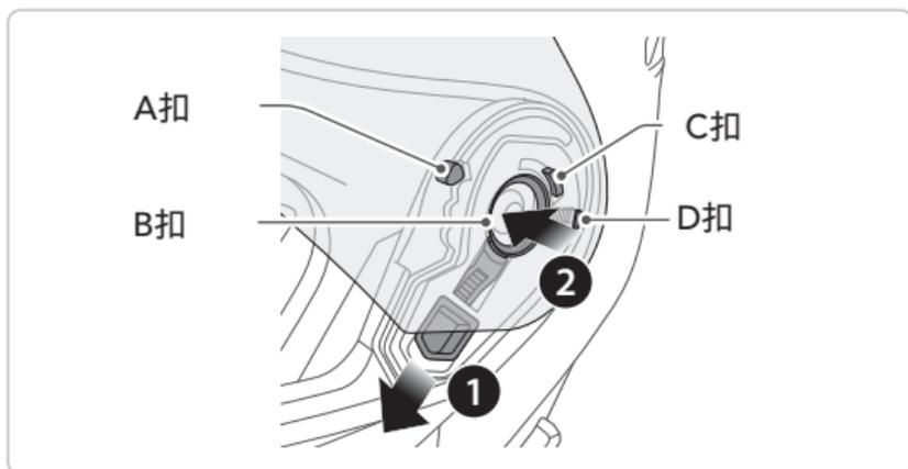
1. 将 A 扣、B 扣、C 扣和 D 扣 对准风镜棘齿，如上图所示。
