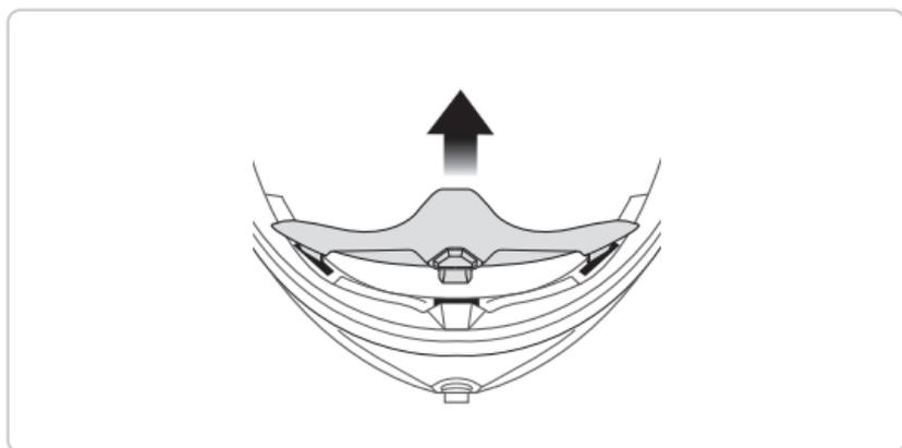
从下颚保护罩上吧呼吸防护装置往外拉，直到完全分离。
