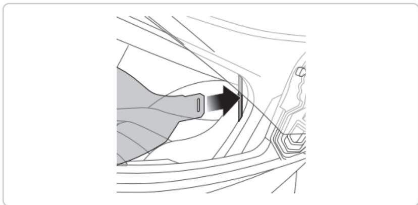
1. 将遮阳镜插到卡槽，直到你听到咔哒一声。
