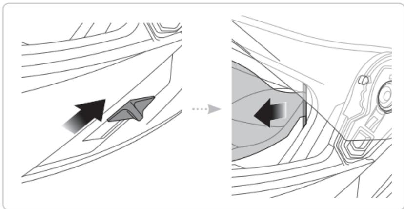
1. 按上图所示的方向滑动遮阳镜卡扣以降低遮阳镜。
