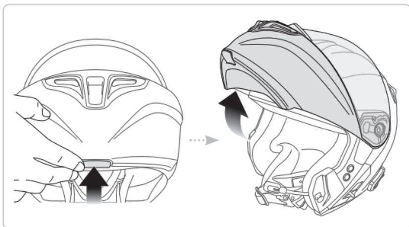
将下颚保护罩开关往外拉，并且将保护罩向上完全掀起。
